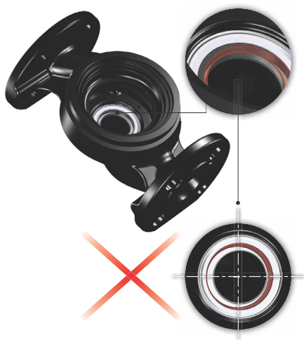
Obr. 17 Nesprávně vystředěná těsnicí soustava
