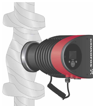
Obr. 19 Izolace tělesa čerpadla a potrubí
